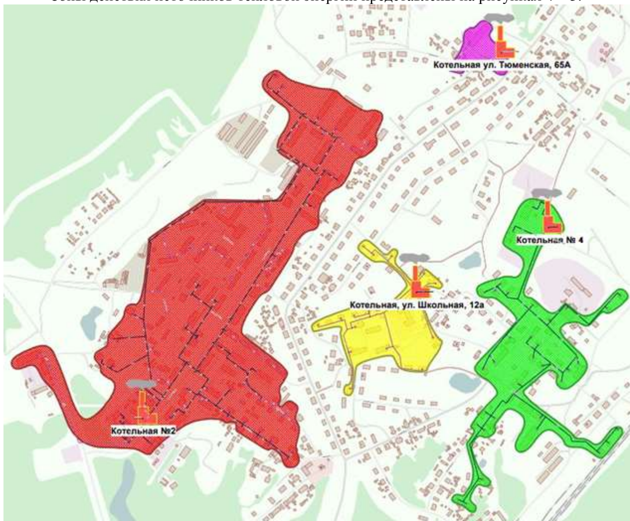
Рисунок 4 – Зоны действия источников централизованного теплоснабжения Таежное ЛПУ МГ ООО «Газпром трансгаз Югорск» (Котельная № 2) и МП МО Октябрьский район «ОКС» (Котельная № 2, п.Уньюган, ул.Школьная, 12а; Котельная № 3, п.Уньюган, ул.Тюменская, 65, строение 1, Котельная № 4, п.Уньюган, проезд Промышленный, 20Д/2) на территории сельского поселения
