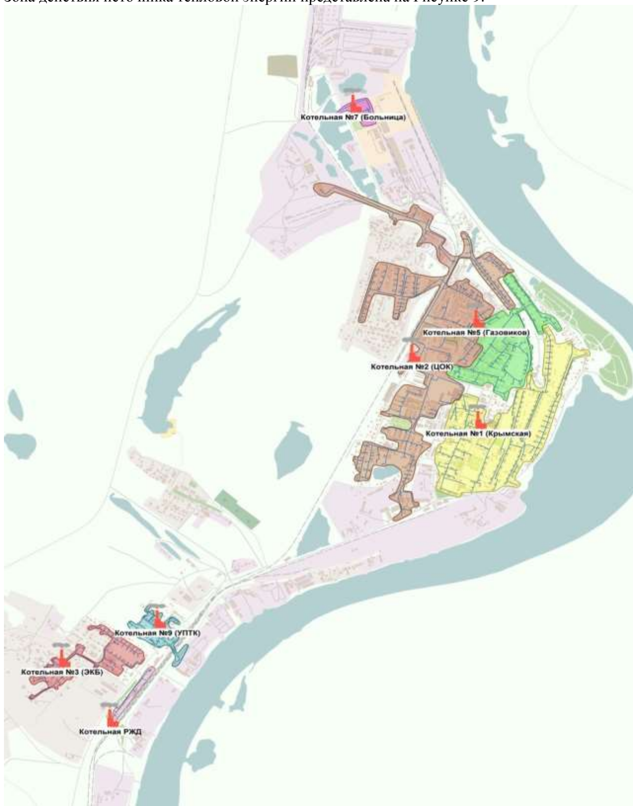
Рисунок 9 – Зоны действия источника централизованного теплоснабжения МП МО Октябрьский район «ОКС» на территории г.п.Приобье
